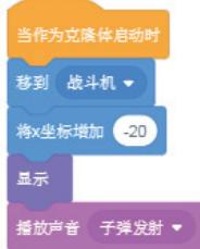
克隆体被创建后，克隆体移至战斗机的位置， $x$ 坐标增加 $-20$ ，将子弹移至战斗机左侧发射子弹的位置。显示克隆体，播放发射子弹音效。
