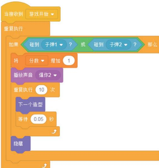
当接收到游戏开始，如果敌机碰到子弹，将变量“分数”增加1，播放敌机爆炸声音，重复执行10次“每0.05秒切换一次爆炸造型”，隐藏敌机角色。
